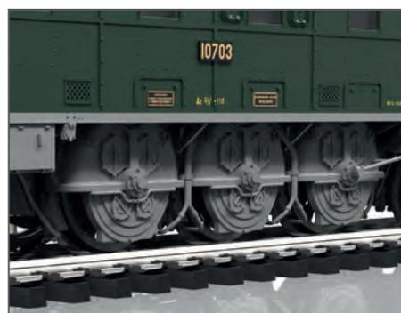
Während auf der rechten Seite die Radsterne gut zu sehen sind, dominiert auf der linken Seite beim Original der Buchli-Antrieb. Umklammert von Sandfallrohren erfolgt beim Original die Übertragung des Drehmoments durch den Gelenkantrieb jeweils auf die einzelnen Achsen.
