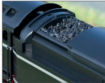
Abdeckung des Kohlenkastens kann geöffnet werden
