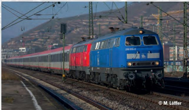
**Vorbild:** Dieselhydraulische Lokomotive der Baureihe 218 der Pressnitztalbahn GmbH (PRESS) in verkehrsblauer Lackierung. Achsfolge Bo´Bo´. Aktueller Betriebszustand.
