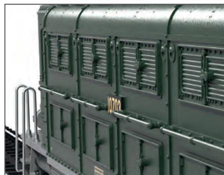
Wie beim Vorbild belegen acht Wartungsklappen die Maschinenraumseite der Lokomotive. Gut zu sehen sind die für die Zeit charakteristisch schweren Verschlussriegel.
